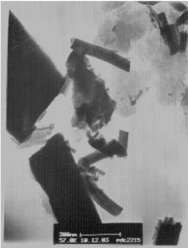
Figura 1 Morfología acicular de los cristales, la barra indica 200 nm
